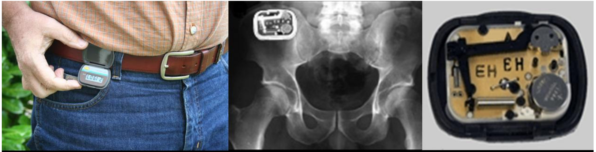
Figuur 1 Plaats en mechanisme van de pedometer
